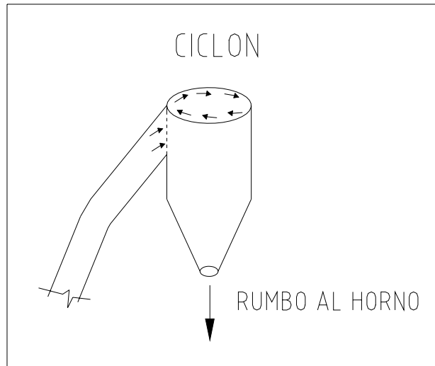
Fig. 3.5.- Ciclón: Extractor de Gases y Polvo
