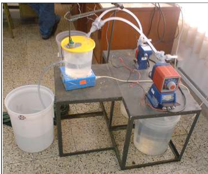
Figura 1.11a Módulo de pH implementado en funcionamiento.
